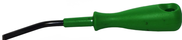
Рисунок 5. Инструмент для монтажа кабеля в клеммы на выводе.
