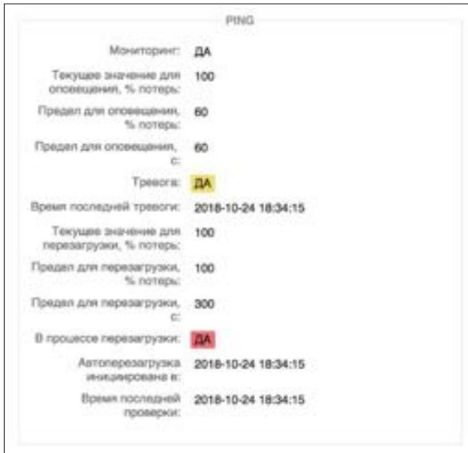
Рисунок 4.11.7. Раздел "Автоматизация" — подраздел "PING" — ("ПИНГ").
