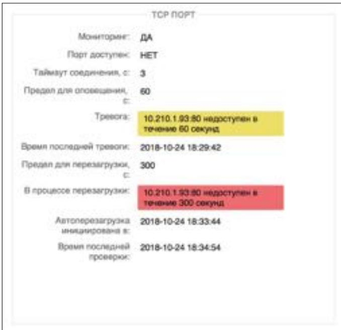
Рисунок 4.11.8. Раздел "Автоматизация" — подраздел "TCP порт".
