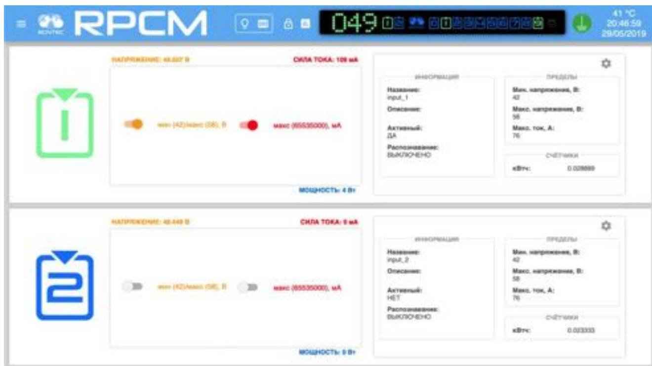
Рисунок 4.4.10. Установка визуализации пределов на примере RPCM DC ATS 76A. Для первого ввода включён режим демонстрации.
