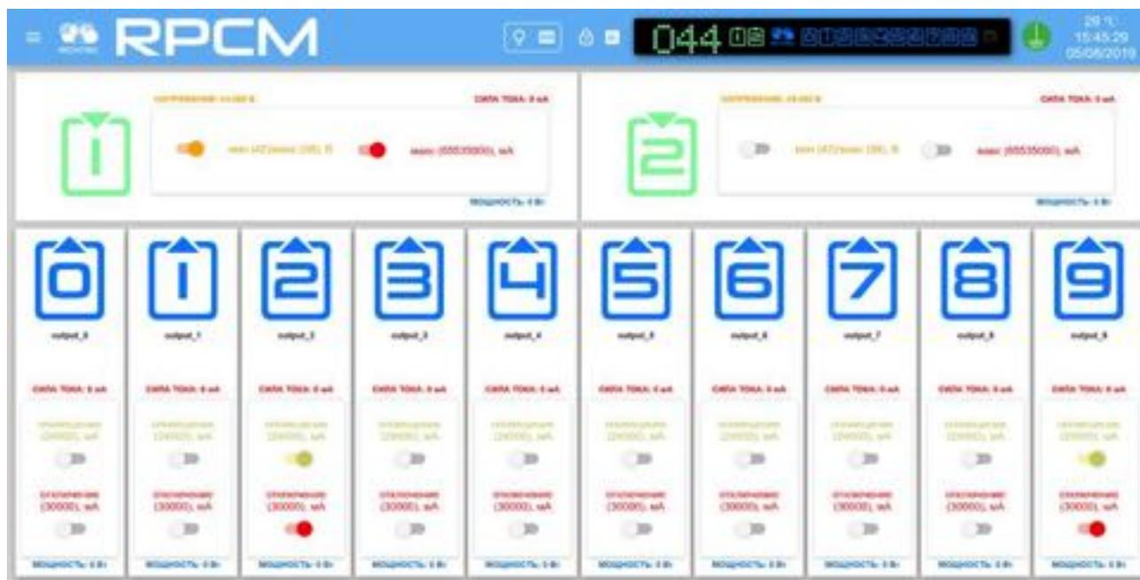
Рисунок 4.2.15. Панель управления Dashboard в режиме вызова настройки демонстрации установленных лимитов RPCM DC ATS 76A с включёнными тумблерами на вводах и выводе. На вводе можно включить демонстрацию лимитов по напряжению и силе тока.
