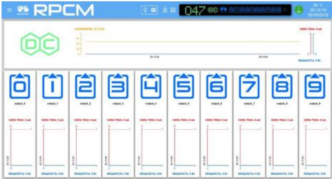
Рисунок 4.2.13. Панель управления Dashboard в режиме просмотра RPCM DC 232A.
