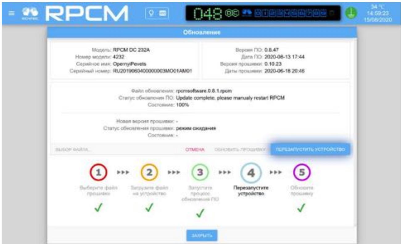
Рисунок 4.7.9. Окно с активной кнопкой для перезапуска контроллера.
