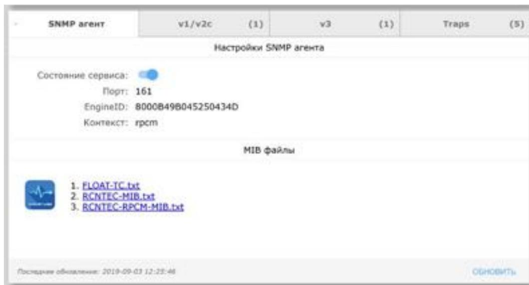
Рисунок 4.6.22. Область управления SNMP. SNMP агент включен.
