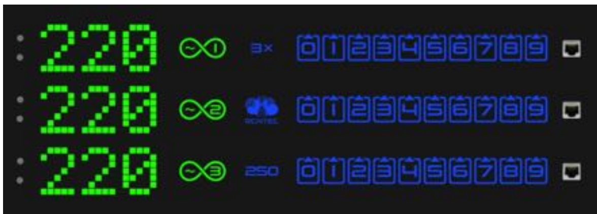
Рисунок 3.1.2. Схематичное изображение индикаторной панели с элементами управления и портами Ethernet для RPCM 3x250.
