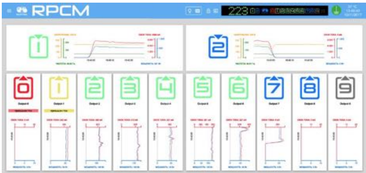
Рисунок 4.2.3. Пример цветовой индикации на панели управления web-интерфейса RPCM — Dashboard.
