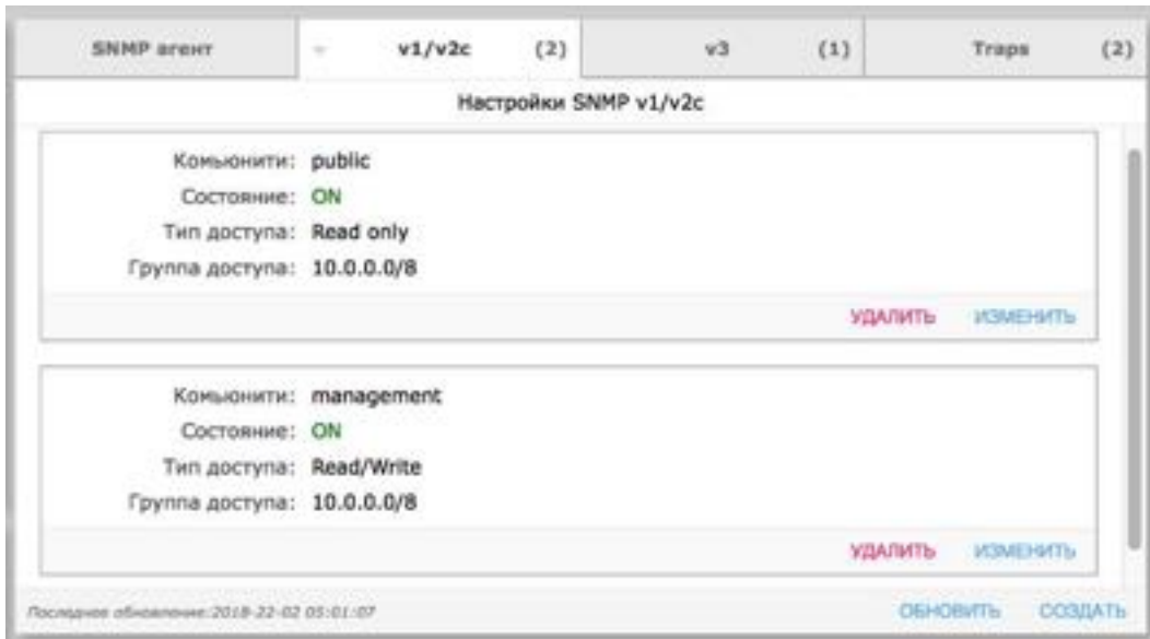
Рисунок 4.6.26. Область управления SNMP, вкладка "Настройки SNMP v1/v2c". Новая запись SNMP community "Read/Write" создана.
