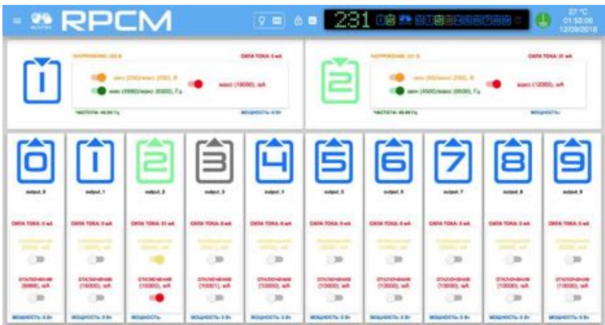
Рисунок 4.2.18. Dashboard в режиме вызова настройки отображения текущих ограничений на графиках RPCM 1502 и RPCM 1532 с включёнными тумблерами на вводах и 2-м выводе.
