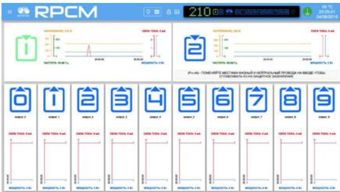
Рисунок 4.2.24. Панель управления Dashboard — оповещение о неправильном (инверсном) подключении фазного и нейтрального проводников на выводе "2".
