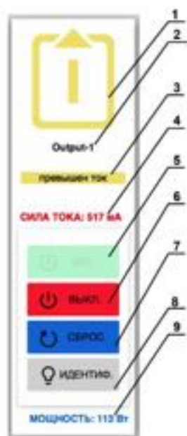
Рисунок 4.2.9. Управление состоянием выводов в режиме управления (Control mode).
