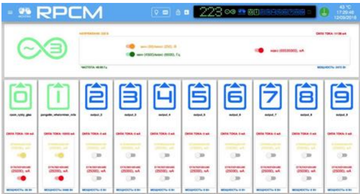
Рисунок 4.2.22. Dashboard в режиме вызова настройки отображения текущих ограничений на графиках 3-го интерфейса RPCM 3x250 с включёнными тумблерами на вводе и 2-х выводах.
